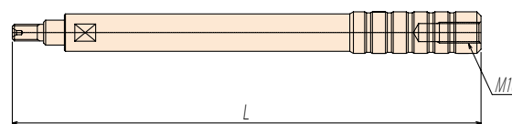
プルボルト取り外し用延長 Bar Extension bar for installing and removing pull bolt
